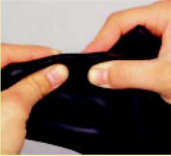
**破裂和开裂：**此类型损坏是由于长时间折叠和挤压造成。
