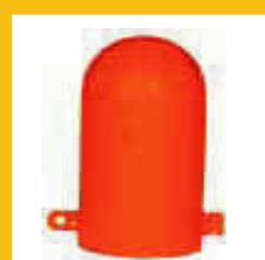
在安装新的电线杆之前安装电杆罩可以防止电线杆和电线发生意外的接触。也可以防止在高空作业吊篮或作业平台上的工作人员接触电杆。电杆罩采用橘红色I型ABS材料制作，强度高，耐低温。Salisbury采用的AIR GAP设计。均衡的间隔凹洞让电杆罩和电杆接触的表面积降到最小。从而大大减少漏电，提高了安全性。当使用两个电杆罩来覆盖较长的电杆时，AIR GAP凹洞可以相互嵌合，将两个电杆罩锁定在一起，形成一个完整的凹洞。这是Salisbury电杆罩的优势。凹洞设计允许空气在电杆罩和电杆之间流动，从而减少了水分和污物的积聚。
