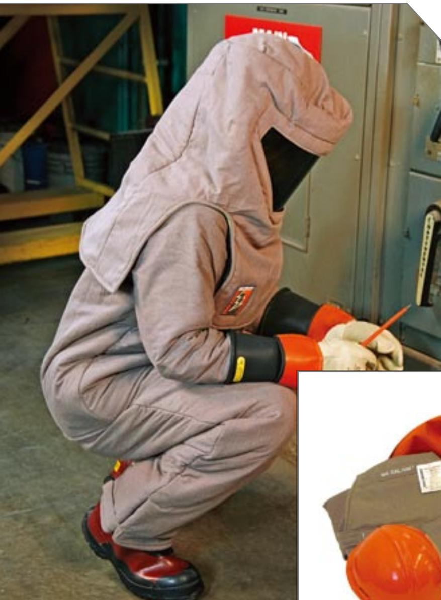
◀ 此Salisbury PRO-WEAR™ 电弧防护装备套件的最低ATPV为40 cal/cm<sup>2</sup>。这个套件包括电弧防护上衣，背带裤，PRO-HOOD®防电弧头罩，安全帽，储存包和安全眼镜。
